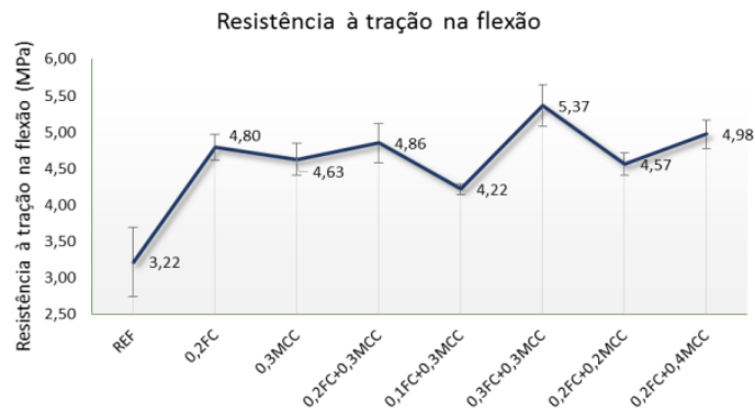
Figura 7: Resistência à tração na flexão aos 28 dias.
