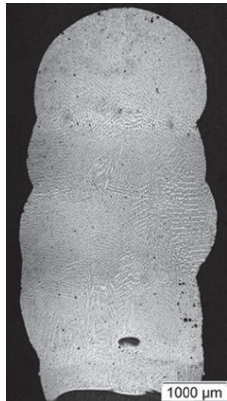
Figura 10. Seção transversal de uma deposição de multicamadas com superliga de níquel, apresentando variação na microestrutura formada ( Fonte: os Autores)
