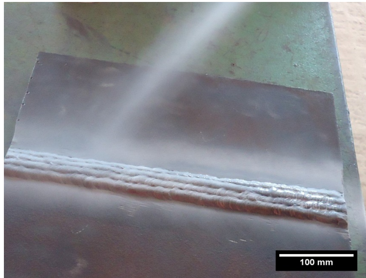
Figura 4. Realização do ensaio por líquido penetrante.
