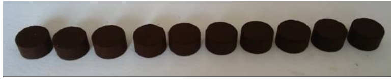
Figura 1: Briquetes moldados somente com pó de borra de café: material passante na malha com granulometria 20 Mesh e retido na malha com granulometria 35 Mesh .
