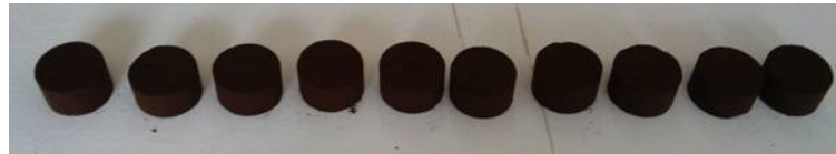
Figura 2: Briquetes moldados somente com pó de borra de café: material passante na malha com granulometria 35 Mesh e retido na malha com granulometria 60 Mesh.
