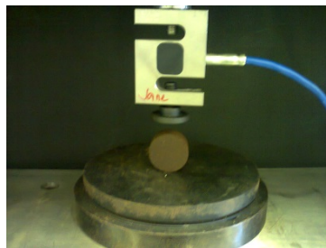
Figura 3: Briquete de pó de borra de café em 35 Mesh durante o ensaio por compressão diametral.
