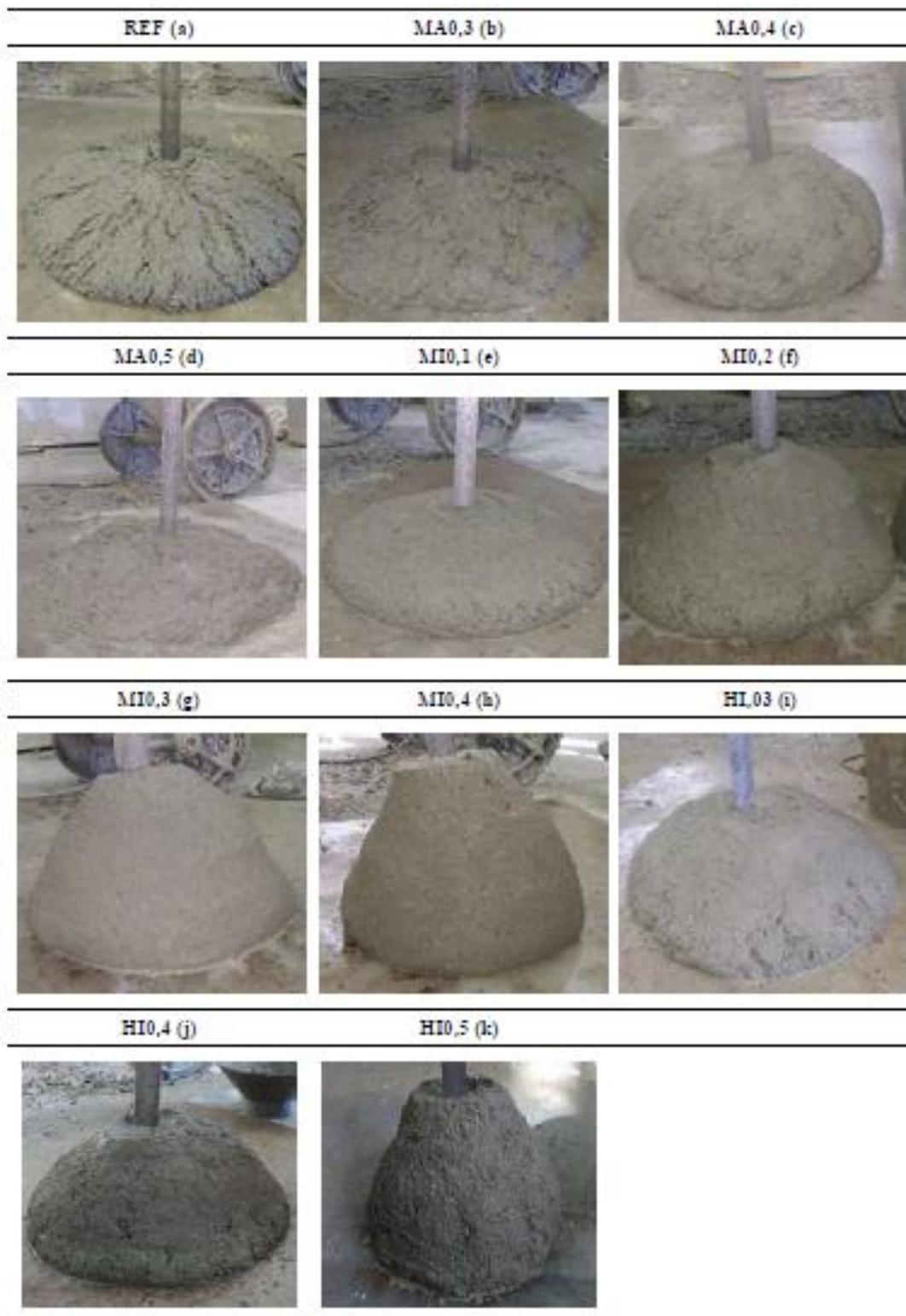
Figura 2: Mistura de referência (a); misturas com adição de macrofibras nos percentuais de 0,3% (b); 0,4% (c) e 0,5% (d); misturas com adição de microfibras nos percentuais de 0,1% (e); 0,2% (f); 0,3% (g) e 0,4% (h); e misturas híbridas nos percentuais de 0,3% (i); 0,4% (j) e 0,5% (k).
