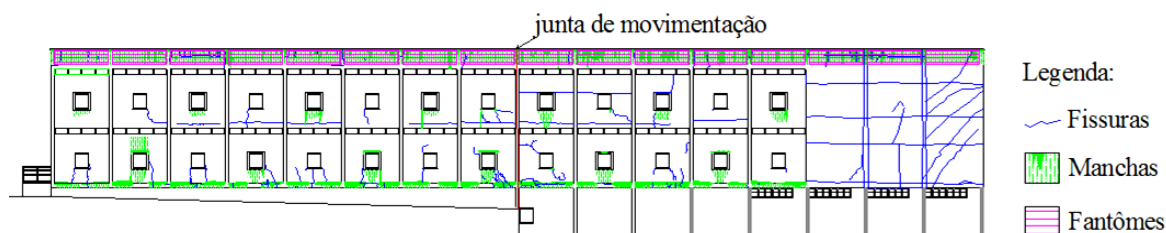
Figura 6 - Mapeamento das manifestações patológicas da fachada norte do Bloco A
