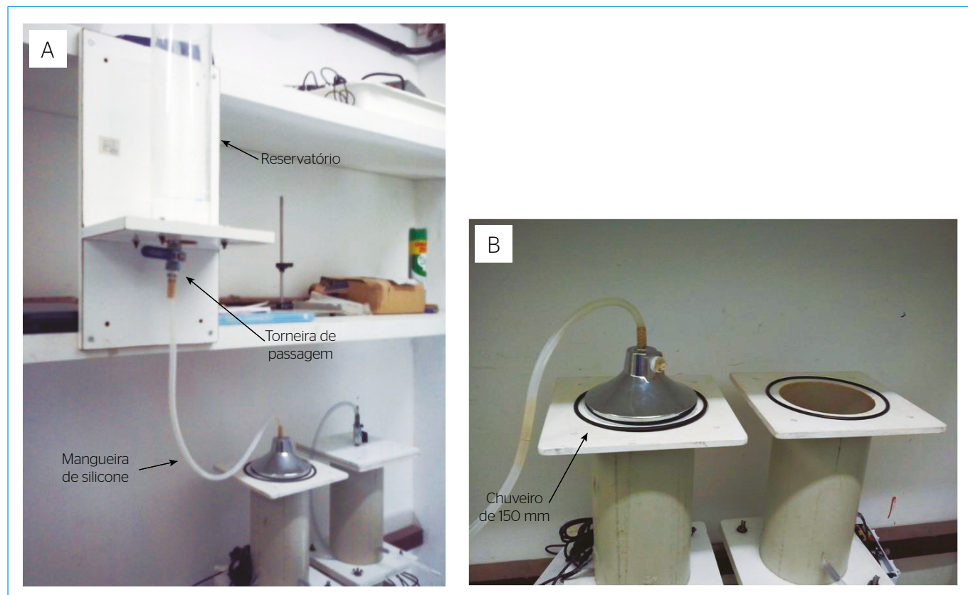
Figura 5 - (A) Sistema construído para umedecimento das colunas; (B) detalhe do chuveiro.
