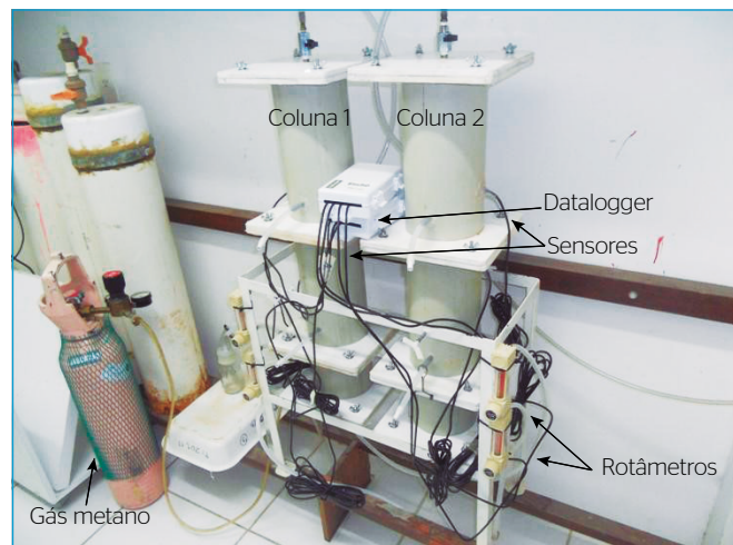
Figura 4 - Sistema de colunas em funcionamento com gás acoplado.
