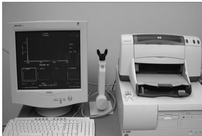
**Figura 1.** Faringômetro (aparelhagem)
