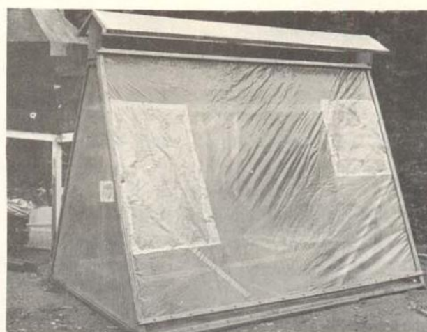
Fig. 4 — Secador tipo casinha, de plástico para secagem do pescado, protegido contra a ação dos insetos.
