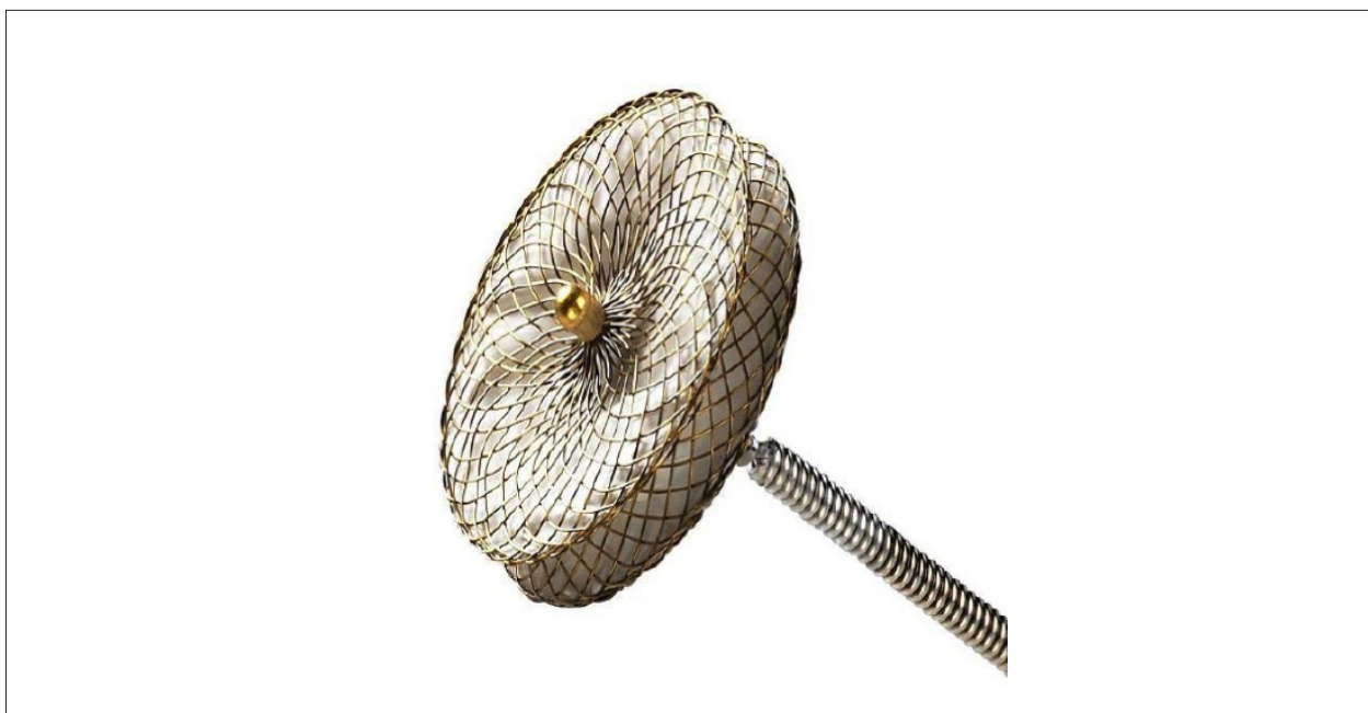
Fig. 2 – Prótese CERA de comunicação interventricular muscular. Prótese feita de malha fina de nitinol com dois discos conectados por uma cintura central de 7 mm de extensão. Internamente, notam-se os retalhos de poliéster ultrafinos (ePTFE). Um cabo de aço de liberação conecta-se ao disco direito por um mecanismo de rosca.
