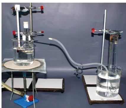
Figura 1. Dispositivo para coleta de gás  $\text{SO}_2$
