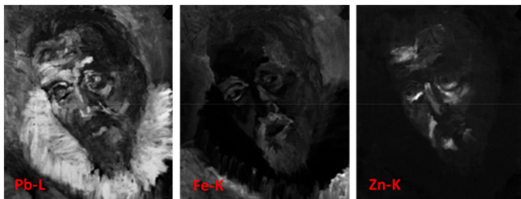
Figura 3. Principais mapas elementares obtidos na tela. Pb-L; Fe-K; Zn-K
