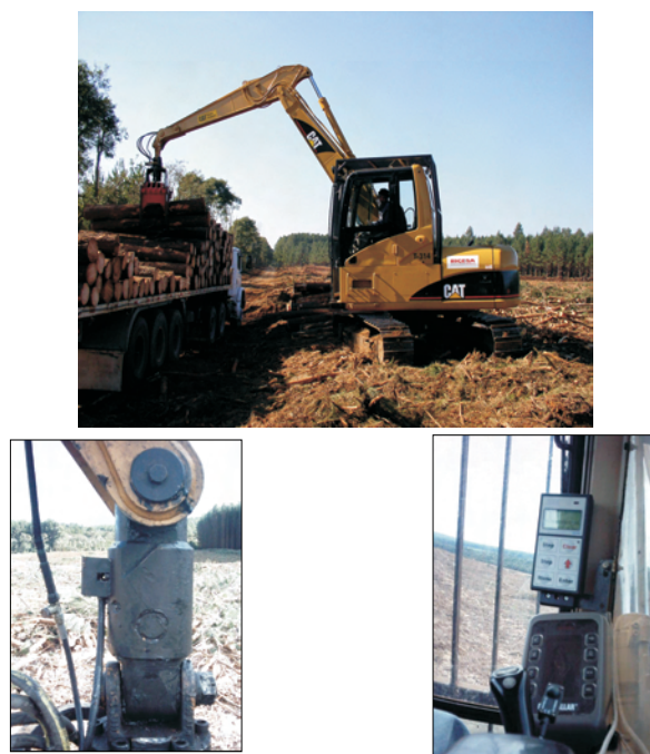
Figura 2 – Balança e computador de bordo do sistema de pesagem TB 300 montados no carregador florestal. Figure 2 – Scale and computer of the TB 300 weighing system of forest loader.
