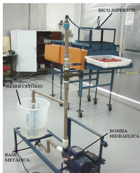
FIGURA 3. Sistema de bombeamento utilizado nos ensaios. Pumping system used on the proposed trials.
