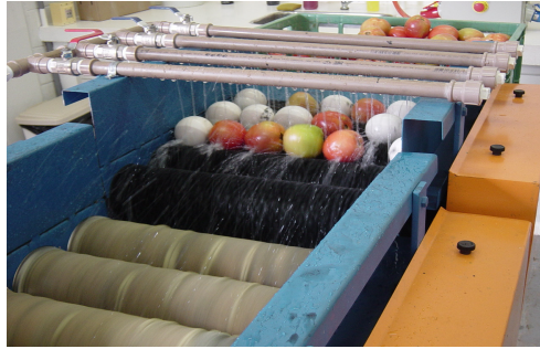
FIGURA 2. Sistema de lavagem convencional. Conventional cleaning system.
