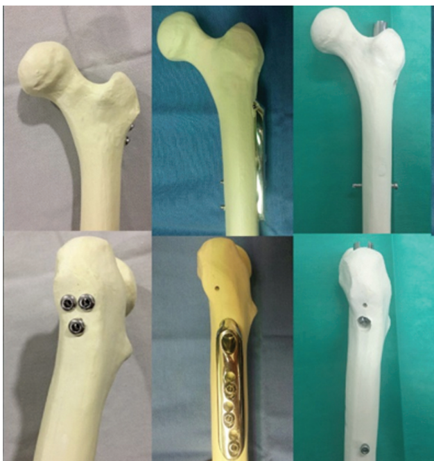
Fig. 2 Amostra de modelos dos grupos GPC, GDHS, e GPFN após colocação do implante.
