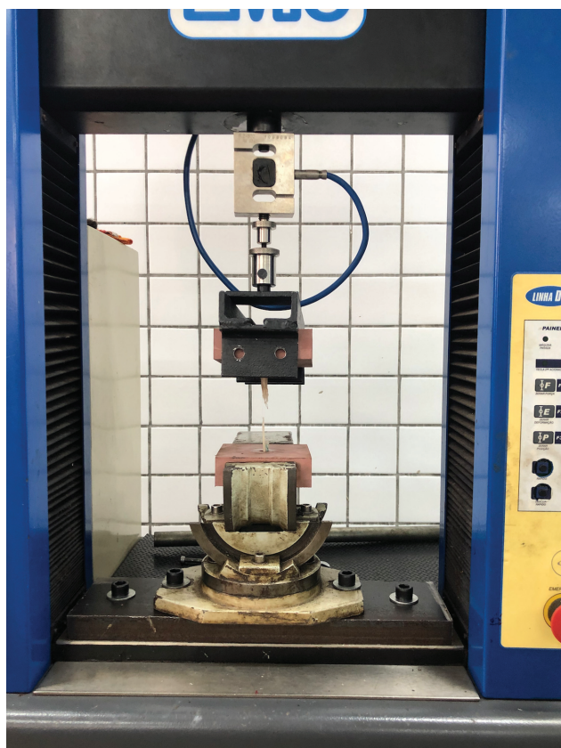
Fig. 4 A amostra (parafuso – bloco – enxerto – bloco – parafuso) na máquina de teste (emic DL 10000 máquina de teste universal eletromecânica).
