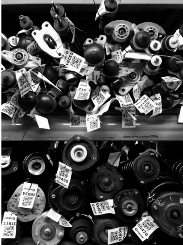
Etiquetas com QR codes, dispositivos físicos que integram o sistema digital de gerenciamento de estoque e anúncios on-line utilizados pelo desmanche de Paulo. Foto de Apoena Mano.
