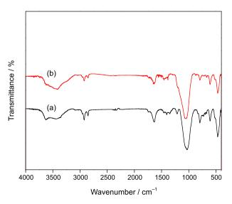
Figure 2. FTIR spectra of (a) fresh  $[Ni(phe)_2(H_2O)_2]/Y$ , (b) recycled  $([Ni(phe)_2(H_2O)_2]/Y$ .
