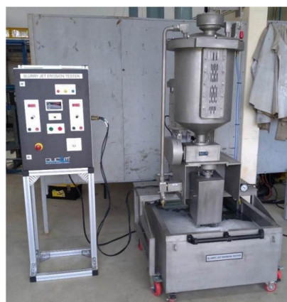
Figura 3. Equipamento de ensaio de erosão por jato de lama - slurry jet tester .
