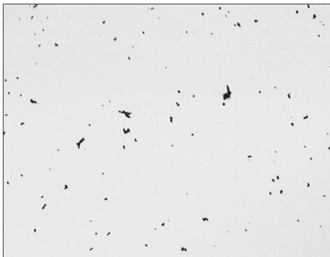
Figura 5 – Imagem de partículas de enxofre formadas no início dos ensaios experimentais
