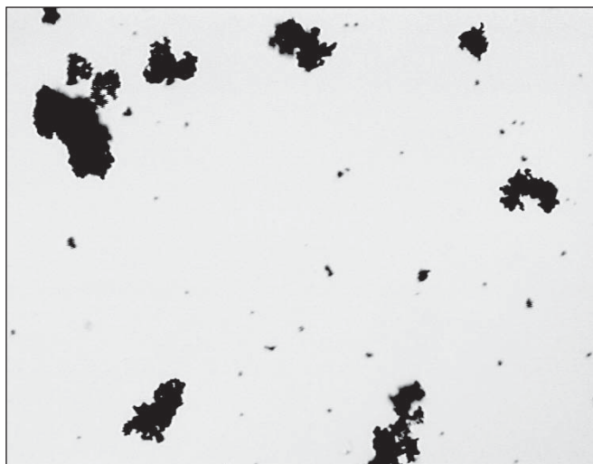
Figura 6 – Imagem de partículas de enxofre formadas após dez horas de ensaios experimentais
