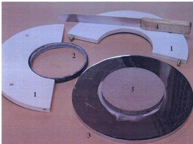
**Figura 7:** Ferramentas para moldagem das amostras para o ensaio de squeeze flow. (1) Gabarito; (2) Anel de PVC para moldagem; (3) Placa inferior; (4) Espátula; (5) Amostra moldada [26].
