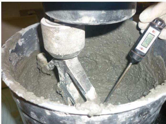
**Figura 6:** Medição da temperatura da argamassa após a mistura.
