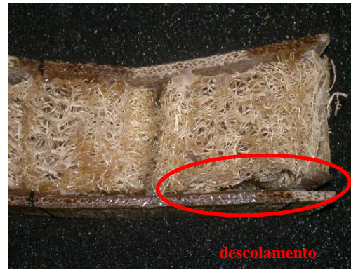
b) Descolamento das faces no núcleo de bucha.
