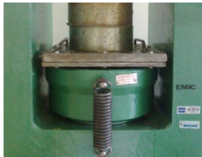
a) Prensagem dos compósitos.
