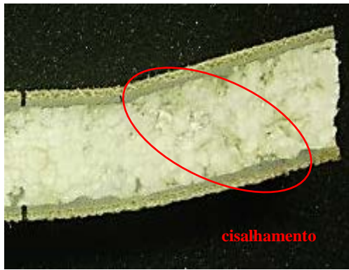
a) Cisalhamento no núcleo de EPS.
