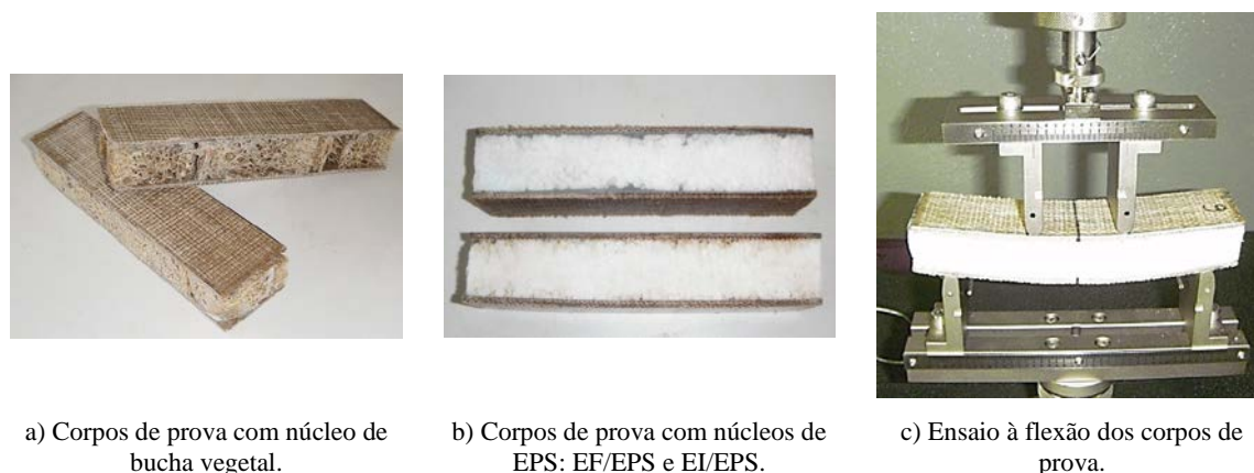
Figura 7: Corpos de prova e ensaios dos painéis sanduíches.
