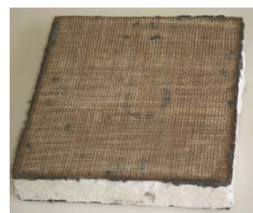
c) Núcleo de EPS e adesivo epóxi cinza.
