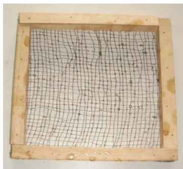
a) Fôrma de madeira com fundo vazado.
