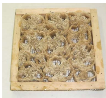
b) Impregnação de bucha vegetal com poliéster.
