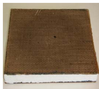
b) Núcleo de EPS e adesivo epóxi incolor.
