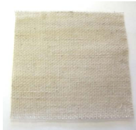
b) Tecido preparado para moldagem.
