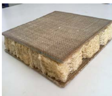
a) Núcleo de bucha vegetal e adesivo poliéster.
