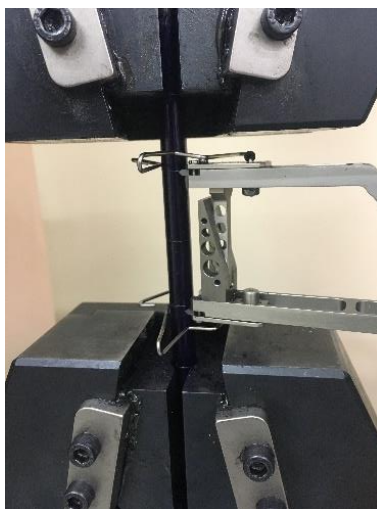
Figura 1: Arranjo experimental mostrando a fixação do corpo de prova nas garras e a montagem do extensômetro durante os ensaios de tração.
