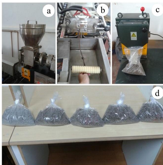
Figura 1: Funil de alimentação da extrusora (a), material conformado em forma de fio sendo resfriado por água na extrusora (b), formação de pellets (c), materiais pelletizados separados por diferentes composições (d).
