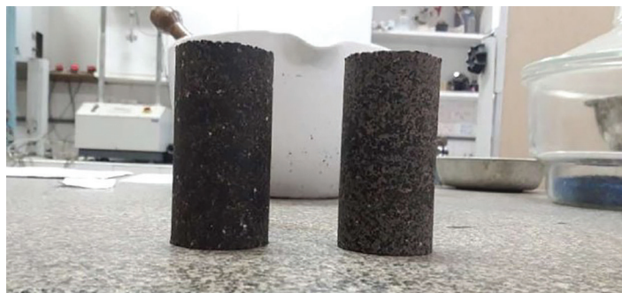
Figura 3: Corpos de prova após compactados e expostos ao ar livre.
