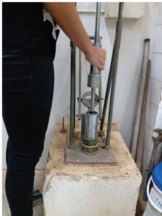
Figura 2: Processo de compactação dos corpos de prova.
