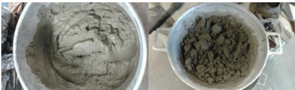
Figura 7: Perda de trabalhabilidade do Formulação A com teores reduzidos de ar incorporado ao final das 48 horas.
