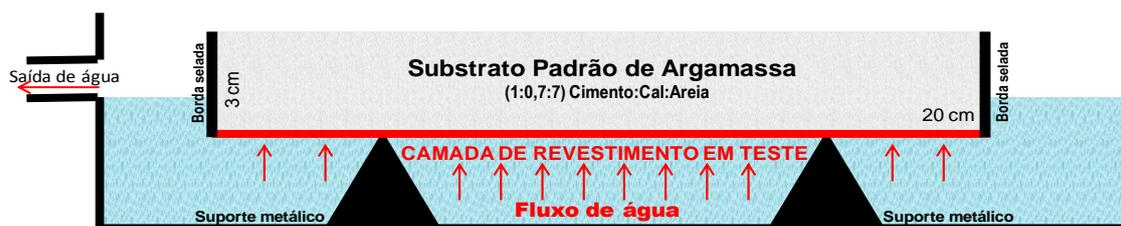
**Permeabilidade ao vapor de água:** o método de ensaio segue as diretrizes da norma EN ISO 12572 (BRITISH..., 2001). Para a realização do ensaio é necessária a utilização de substrato com velocidade de transmissão de vapor de água superior a 240 g/(m<sup>2</sup>/dia). Nos ensaios realizados, o substrato utilizado, blocos de concreto celular autoclavado, apresentou velocidade de transmissão de vapor de água de 262 g/(m<sup>2</sup>/dia).
