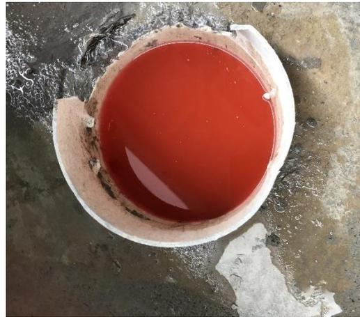
Figura 6 - Vedação das saídas da calha para ensaio de estanqueidade
