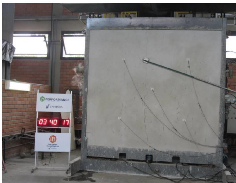
Figura 9 - Amostra EST 140: Realização de teste de estanqueidade aos 220 minutos
