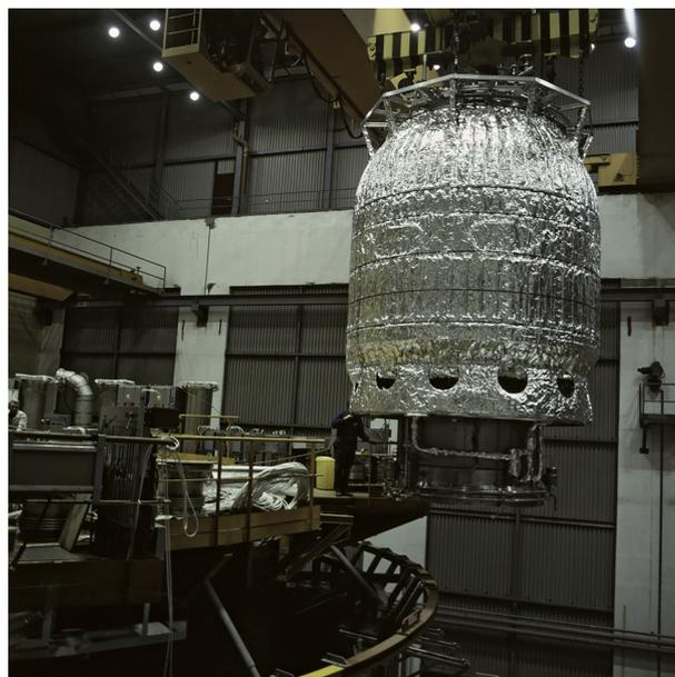
**Figura 3:** (Colorida online) O corpo da câmara do Big European Bubble Chamber (BEBC). Foto tirada durante uma manutenção da câmara de bolhas, em dezembro de 1980. (Fonte: atualização da foto original pela extraída da Ref. [7].)
