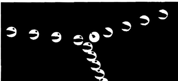
**Figura 11:** Fotografia estroboscópica de uma colisão elástica entre uma bola de bilhar entrando, pela esquerda, e uma outra bola de bilhar estacionária. A imagem foi tirada com múltiplos flashes no intervalo de tempo regular de  $30 \text{ milissegundos}$  (de PSSC). (Fonte: figura original da Ref. [1].)
