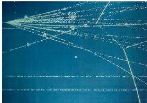
**Figura 15:** (Colorida online) Interação entre um próton de  $28 \text{ GeV}/c$  e um próton da câmara de bolhas de hidrogênio. Na interação, são produzidas 16 partículas carregadas e também várias partículas neutras. (cortesia do CERN, Genebra). (Fonte: substituída pela figura idêntica extraída, com melhor qualidade, da Ref. [20].)
