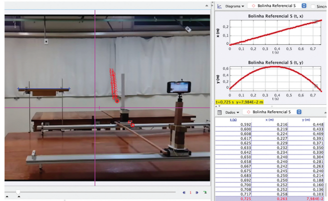
Figura 9: Videoanálise do movimento da bolinha a partir do referencial S , com a base balística executando um movimento horizontal no mesmo sentido do fio tensionado.
