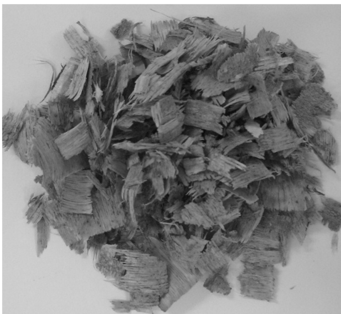
FIGURA 1: Partículas da madeira de canafistula ( Peltophorum dubium ) utilizadas na confecção das chapas. FIGURE 1: Wood particles of canafistula wood ( Peltophorum dubium ) used to manufacture the particleboard.
