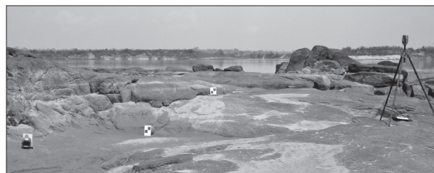
Figura 11. Aquisição de dados com o laser scanner na ilha Dionísio. Foto: Scientia Consultoria Científica.
