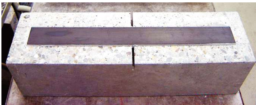
Figura 7 – Viga de concreto entalhada reforçada com o sistema Sika® Carbodur
