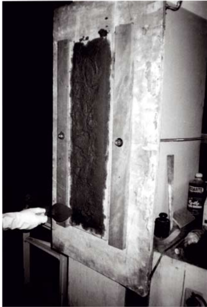
Figura 2 - Aplicação da argamassa na placa
