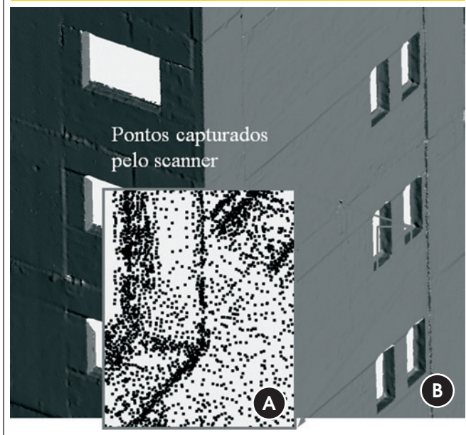
Figura 2 - (a) Ilustração de uma nuvem de pontos capturada pelo escâner (Fonte: T1 Engenharia); (b) modelo 3D processado a partir da nuvem de pontos capturada pelo escâner
