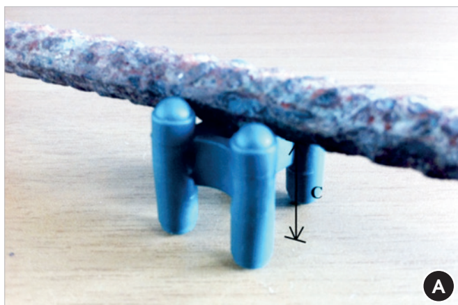
Figura 7 – Método de avaliação do requisito dimensional: a) em espaçadores tipo cadeirinha; b) em espaçadores circulares
