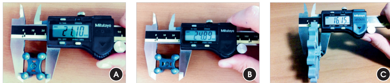
Figura 8 – Medição das dimensões dos espaçadores tipo cadeirinha: a) medida paralela ao posicionamento da barra; b) medida perpendicular ao posicionamento da barra; c) medida do centro de apoio do espaçador circular
