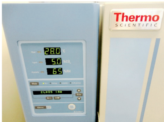
Figura 2 Câmara de carbonatação – condições de exposição dos corpos de prova
