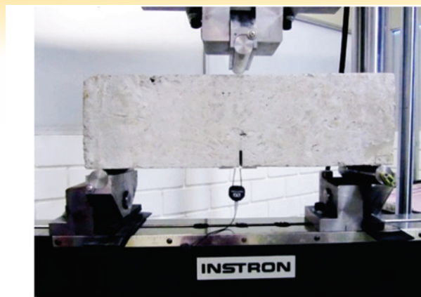
Figura 1 Ensaio à flexão em três pontos (EN 14651 [7]), medidas em mm
