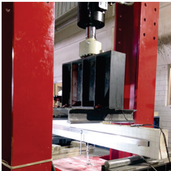
Figura 7 Pórtico para o ensaio à flexão em quatro pontos
