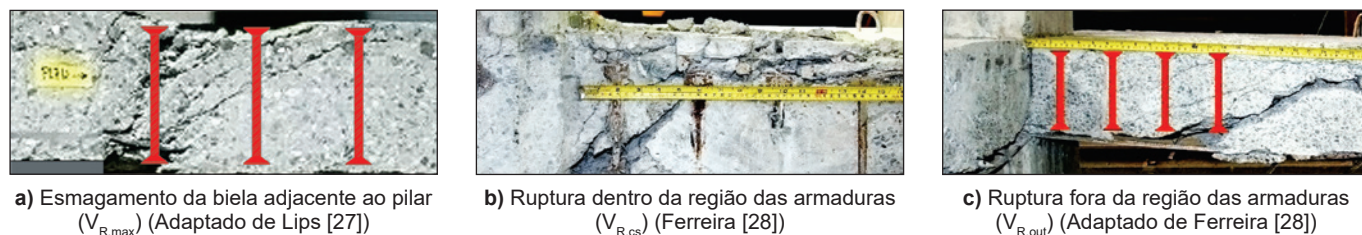
Figura 5 Modos de ruptura por punção em lajes armadas ao cisalhamento
