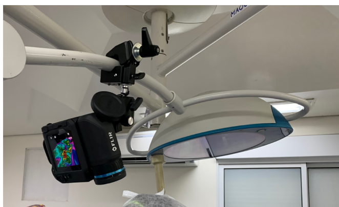
Figura 3. Fixação da câmera no foco cirúrgico.
