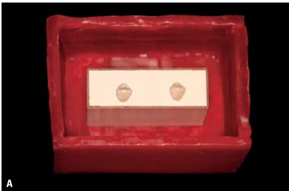
FIGURA 3 - Posicionou-se a matriz dentro da caixa de cera (A) e verteu-se silicone (B) para obtenção do negativo.
