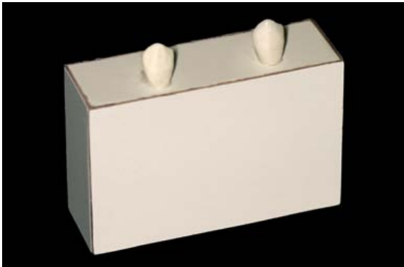
FIGURA 1 - Matriz confeccionada de fôrmica para servir de duplicador. Observa-se o posicionamento das coroas dos caninos que serviram de parâmetro para o modelo fotoelástico.
