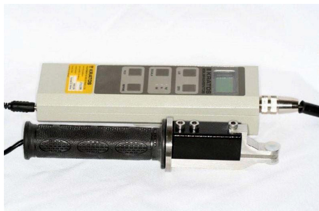
Figura 1. Dinamômetro digital com capacidade até 100 quilogramas-força (Kgf)
