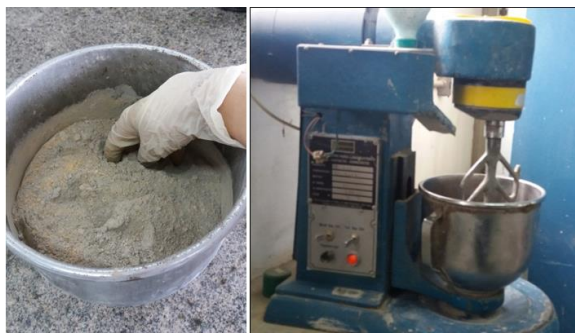
Figura 1: Etapa de homogeneização das matérias-primas.
