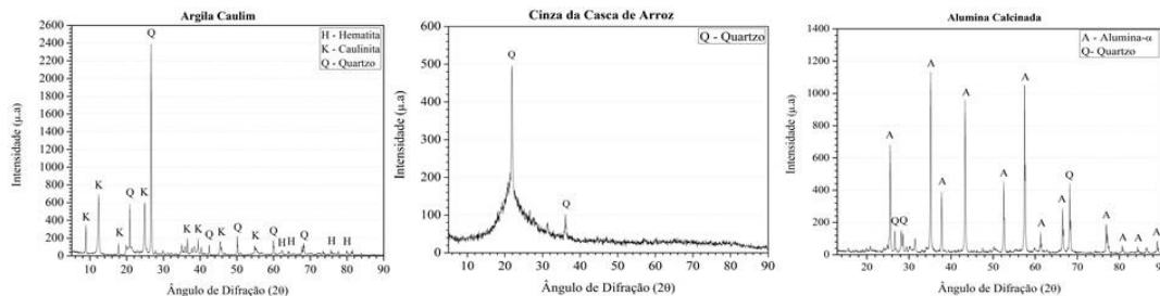
Figura 4: Difratoograma das matérias-primas que foram utilizadas na fabricação das cerâmicas refratárias.
