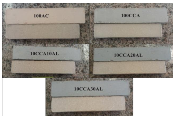
Figura 6: Retração linear de queima das amostras.
