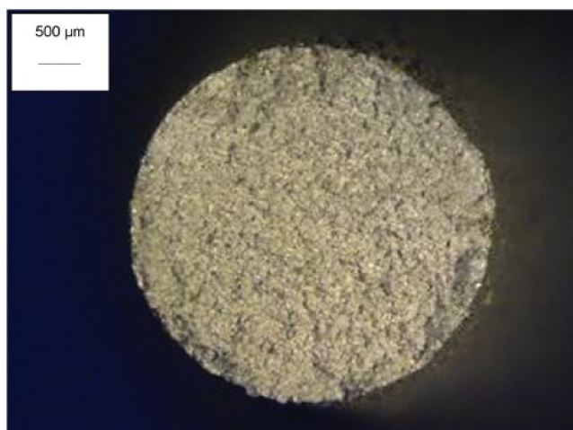
Figura 5: Fractografia via estereomicroscópio evidenciando toda a seção transversal do cdp sem entalhe ensaiado com \sigma_{\text{máx}} de 500 MPa na condição AA7075-Nitretada.
