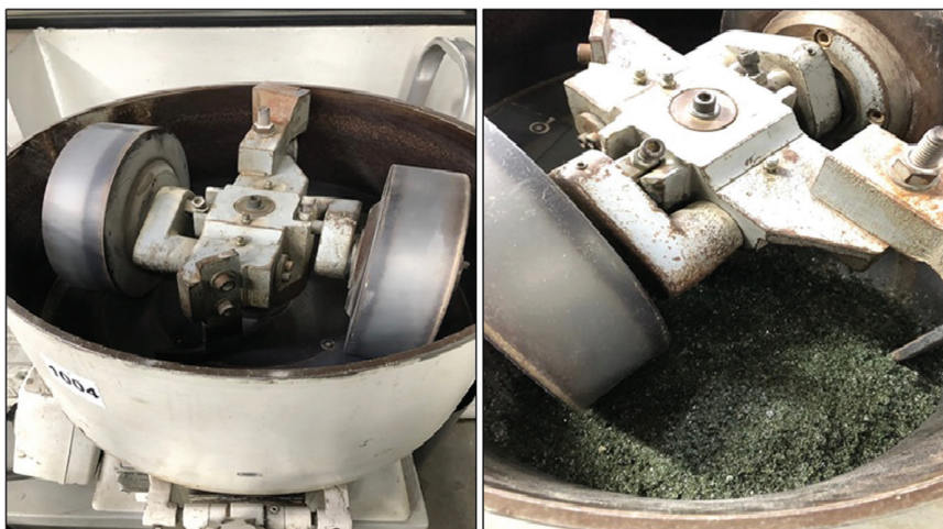
Figura 1: Misturador de mós verticais utilizado para ajustar a granulometria das escórias.
