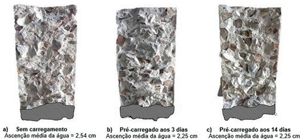
**Figura 9:** Ascensão da água após ensaio de absorção aos 76 dias – aditivo cristalizante X.
