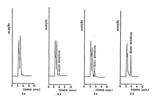
Cromatograma de Amostras coletadas durante a elaboração de Iogurte Natural. Fa-Fig. 3. se movel: metanol/tampão fosfato, pH 4,5 (50/50, v/v); fluxo = 0,7 ml/min.; ate nuação: 0,2X; Detector: UV - 227 nm.
