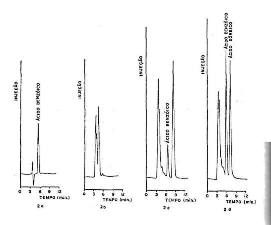
Cromatograma de diferentes amostras de logurte. Fase movel: metanol / tampão fosfato, pH 4,5 (50/50, v/v); fluxo = 0,7 ml/min.; atenuação: 0,2X; Detector: Fig. 2. UV - 227 nm.
