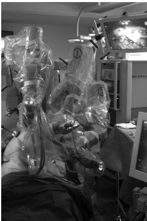
FIGURA 2 - Acoplamento dos braços robóticos aos trocárteres ("docking")
