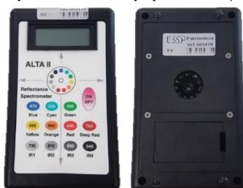
O amplo uso do ALTA II nas pesquisas a respeito da envoltória da edificação pode ser observado no Quadro 1, o que reforça a necessidade de confirmar sua confiabilidade para a medição da refletância solar de telhas e materiais para a cobertura das edificações.
